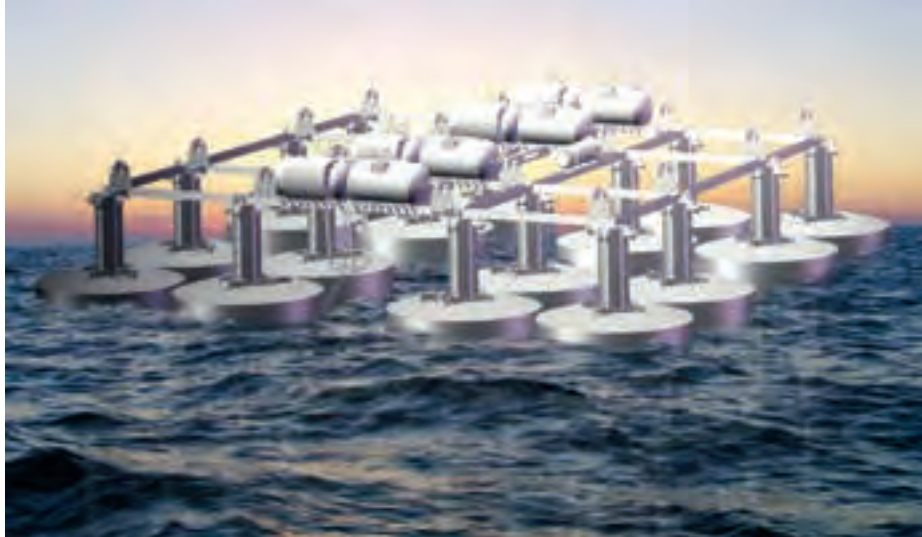
Imágenes virtuales de la "Plataforma Generadora de energía undimotriz (6 MW) Calma 1", de Hidroflot, en las que se aprecia las partes sumergidas.
