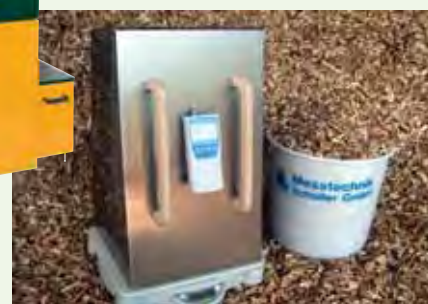
Arriba, piscina climatizada por Herz Altersun, y debajo, por orden, las “tripas” de la instalación de Herz, una trituradora de Untha Motorgarden, una caldera KWB Multifire USV 40 (silueta) y el medidor de contenido de agua en biomasa Humimeter.
