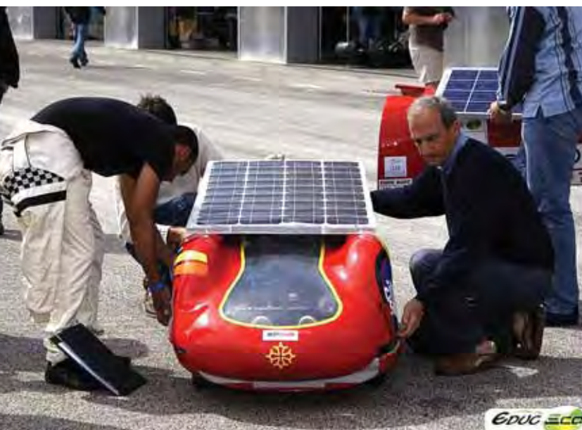
Arriba, este prototipo francés funciona con la electricidad generada por el módulo fotovoltaico. A la derecha, el "Salzillo II", Desarrollado por la Universidad de Murcia, está adaptado para funcionar con etanol. Abajo, el "ECO-MARXA", prototipo que circula 400 kilómetros con sólo un litro de gasolina
