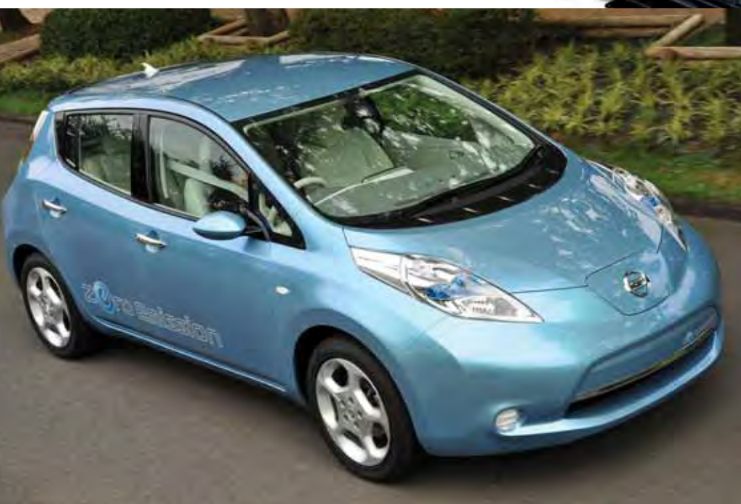
El Nissan LEAF se ha diseñado desde el principio como vehículo eléctrico lo que ha permitido situar las baterías en dos filas debajo de los asientos delanteros y traseros para poder reemplazarlas rápidamente.
