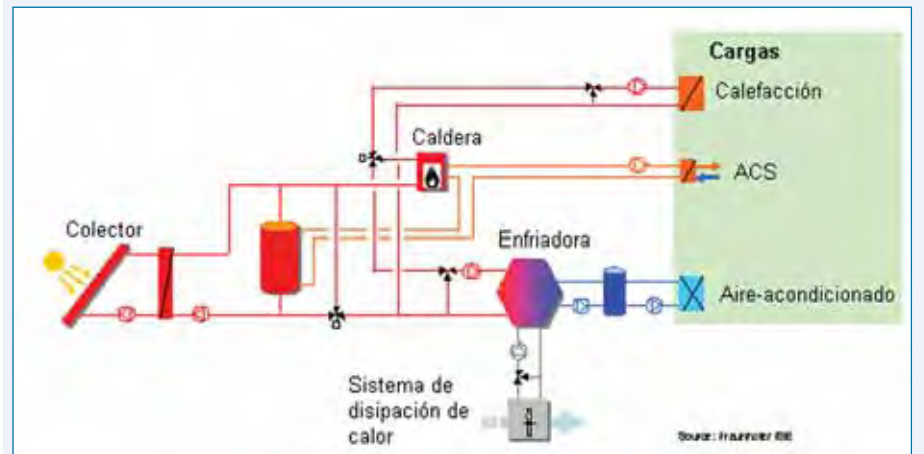
Configuración C1, simulada para ClimateWell 10, Sonnenklimate Suninverse y Rotartica Solar 4-5
