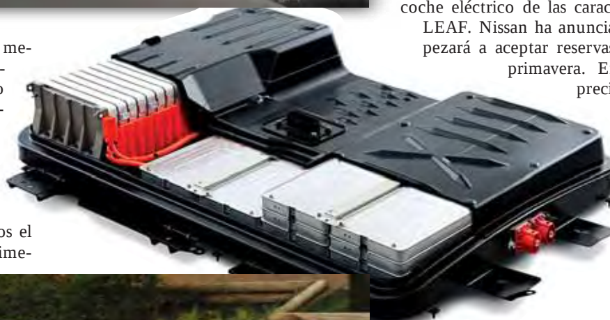
El Nissan LEAF se ha diseñado desde el principio como vehículo eléctrico lo que ha permitido situar las baterías en dos filas debajo de los asientos delanteros y traseros para poder reemplazarlas rápidamente.
