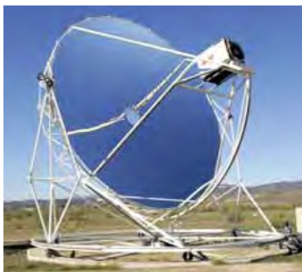
A la izquierda, concentrador cilindro parabólico (CCP); junto a estas líneas, disco solar con motor Stirling: dos tecnologías termosolares representadas en la PSA
