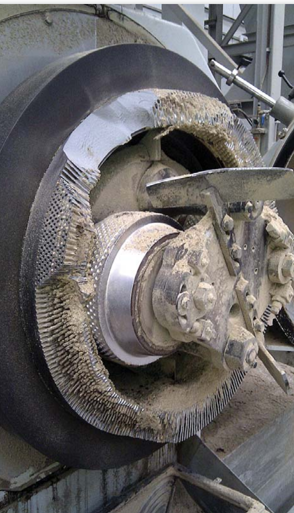
Imágenes que muestran los desperfectos que sufrió la matriz de seis milímetros y la rotura del rodillo, incidencias ambas producidas durante las pruebas de fabricación de pélets industriales de calidad. En la página siguiente, fábrica de la empresa Pellets Asturias, en Tineo, una de las instalaciones en las que se han realizado los ensayos de fabricación.
