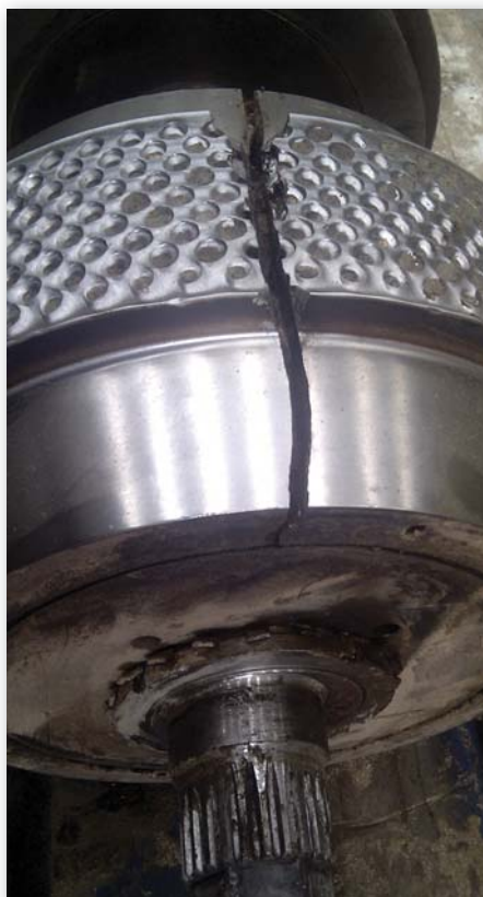
Imágenes que muestran los desperfectos que sufrió la matriz de seis milímetros y la rotura del rodillo, incidencias ambas producidas durante las pruebas de fabricación de pélets industriales de calidad. En la página siguiente, fábrica de la empresa Pellets Asturias, en Tineo, una de las instalaciones en las que se han realizado los ensayos de fabricación.
