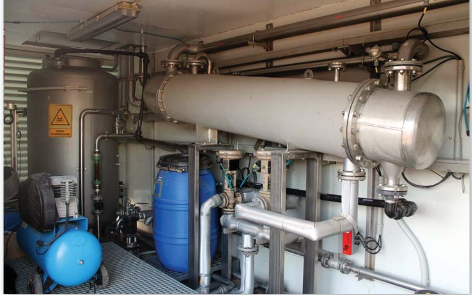
Área de regeneración de la amina. La columna horizontal es la torre de destilación de la amina.
