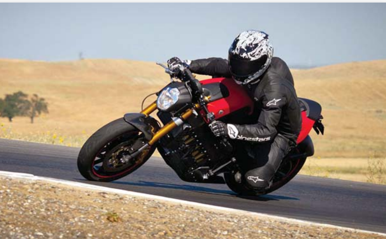
Brammo Empulse (40 kW; capacidad de la batería: 6 kWh; 124 kilómetros de autonomía en circulación mixta urbana-interurbana; 213 kilogramos de peso; aproximadamente 6 horas de recarga; 169 kilómetros por hora de velocidad máxima; unos 15.000 euros).
