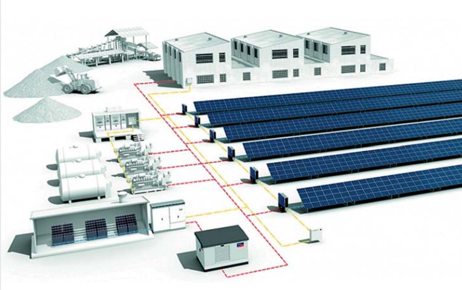
Esquema de la planta. En la foto inferior, las baterías de ion-litio de Saft aportan inercia al sistema.
