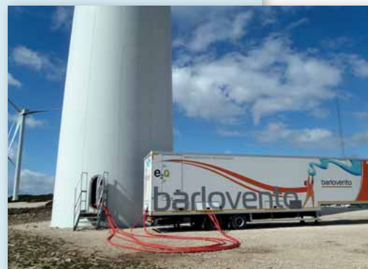
Unidad de ensayos de huecos de tensión en el Parque Eólico de Aláiz (Navarra).
