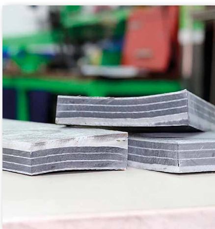
Arriba a la derecha, recogida de la pala en el P.E Bon Vent Vilalba. Sobre estas líneas, recepción y preparación del material para su tratamiento y, a la derecha, reciclaje mediante tecnología R3FIBER
