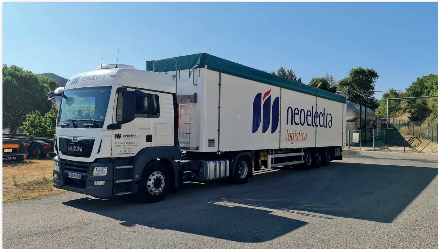
Arriba, semirremolque de piso móvil especial para el transporte de biomasa. A la izquierda, planta de cogeneración por biomasa en Neomas (Chile), que genera electricidad y vapor
