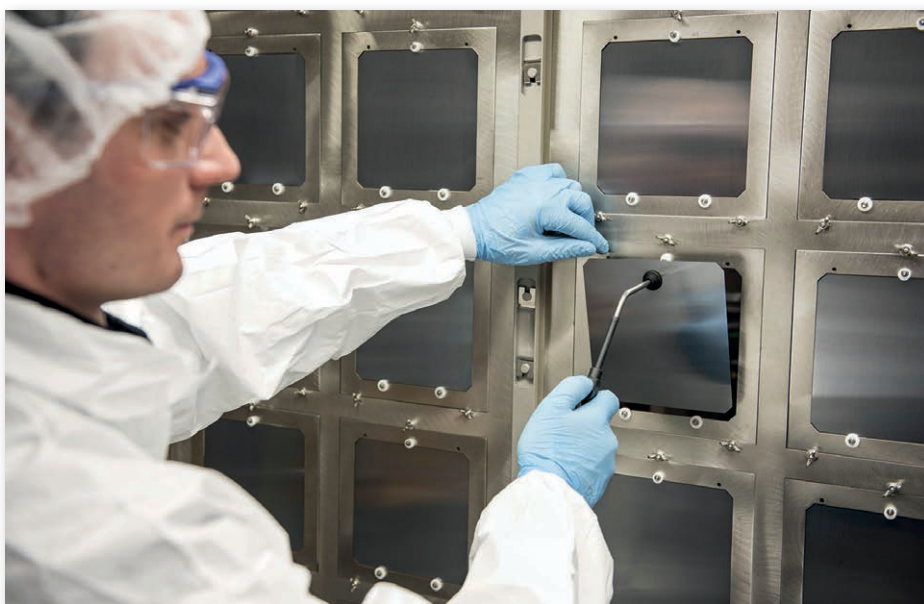
Celdas solares en tándem de perovskita-silicio de Oxford PV de 156 mm x 156 mm en la línea piloto industrial de la compañía, Alemania
