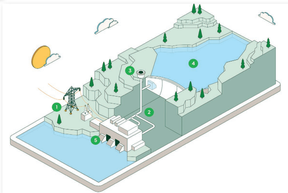
Cómo funciona una central de bombeo. 1) Exceso de energía renovable; 2) Bombeo del agua; 3) Regulación del sistema hidráulico; 4) Almacenamiento en el embalse superior; 5) Lista para generar energía. Infografía: Iberdrola
