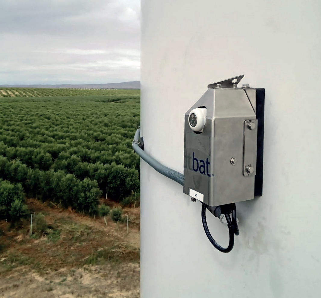
Uno de los micrófonos de un sistema DTBat instalado en un aerogenerador. Fuente: DTBird.
